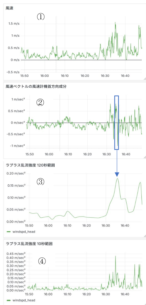
図 8 ラプラス乱流強度計算方法
