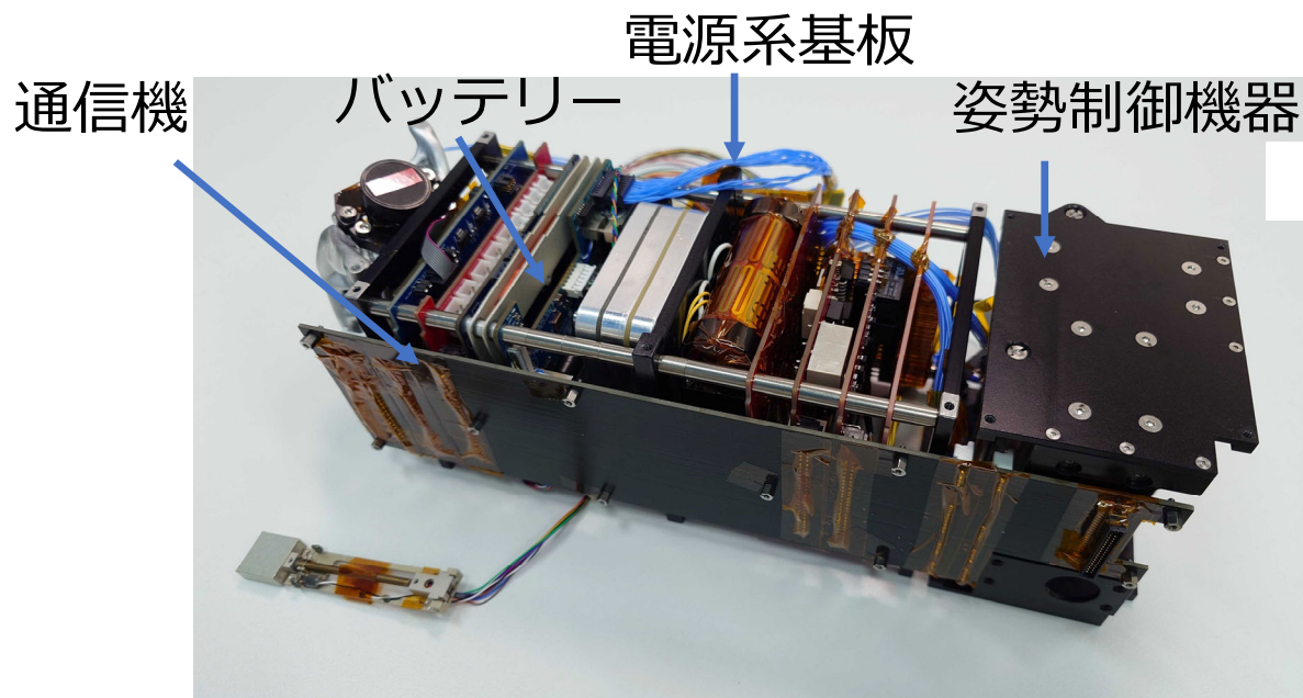
衛星バス基板ユニットの組み上げ確認/電気統合試験
