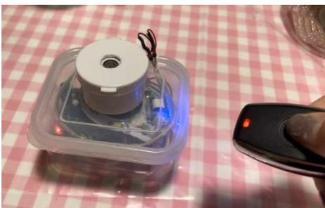
図6 遠隔操作できる小型加湿器
