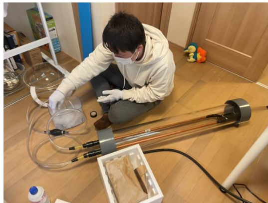
図6 アクリルパイプを用いた真空冷却装置の稼働
