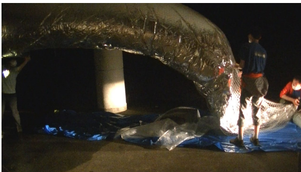
図 4. 浮揚ガスの封入作業
