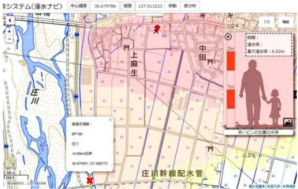
中田中学校(避難所)の浸水シミュレーション(浸水ナビを利用)
