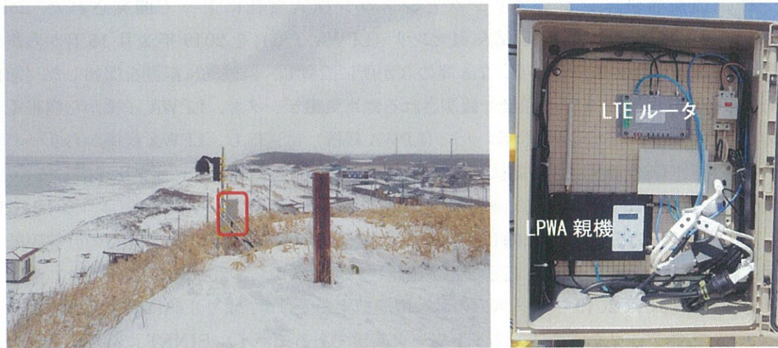
図 3.2 小清水町浜小清水のフレイト展望台敷地内に設置した汎用型通信ユニット（左、赤枠）。LPWA 親機とモバイル SINET に対応した汎用 LTE ルータの写真（右）。蟹気楼を測定するカメラと併設している。
