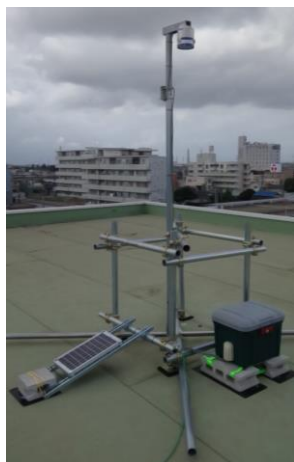
図 1 独自開発した静電気計測システムの全体像外観
