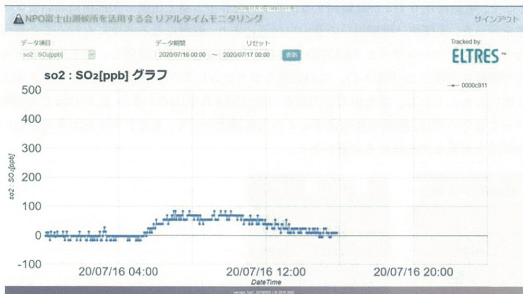
図 2-2 富士山頂での越冬システムによる火山性ガスのリアルタイム測定を NPO のウェブサイト公開している画面の例
