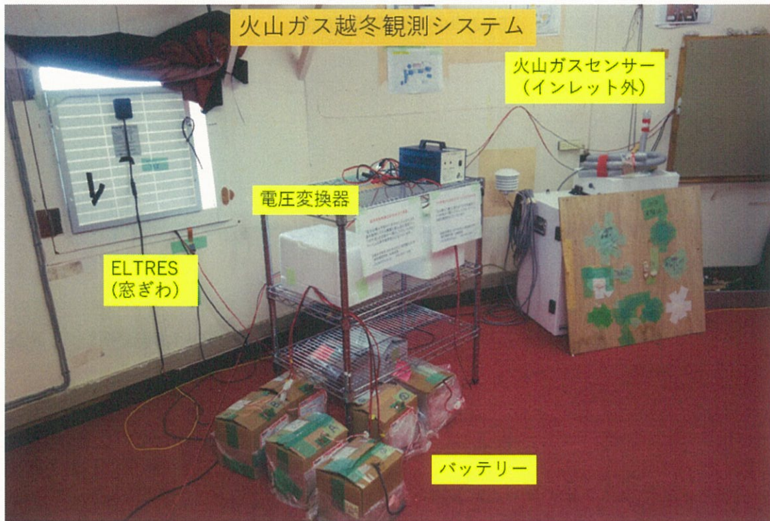
図 2-1 2019 年 8 月末に富士山頂に設置した火山性ガス越冬観測システム
