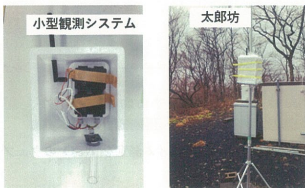
図 3-1 小型の火山性ガス観測システムと富士山麓太郎坊でのテスト測定の様子
