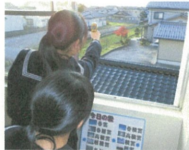
図2 放射温度計による雲底温度の測定
