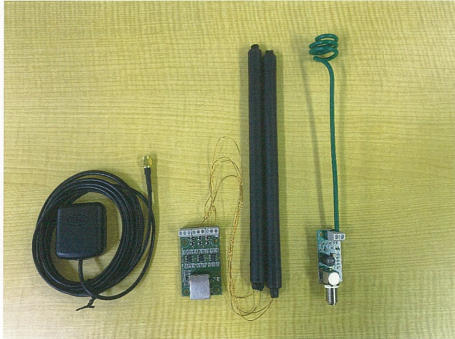
図 2.3 受信機に接続するアンテナ
