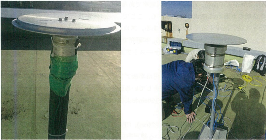
図3.1.1 平行円板アンテナ (a)千葉大アンテナ(CF33) (b)Boltアンテナ
