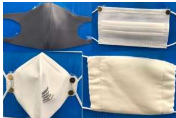
Fig. 6 各マスクの写真(左上から時計回りにウレタン、不織布、ガーゼ、N95)
