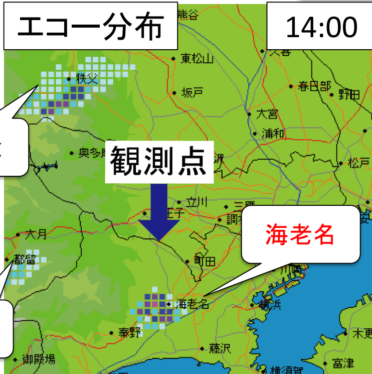
図6 2014年9月6日14:00頃に神奈川県海老名市上空で発生した積乱雲のエコー分布(左図)と、積乱雲に対応すると思われる静電界変動(右図)
