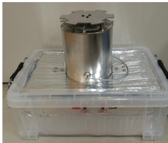
図6 回転形電界計測器の外観
