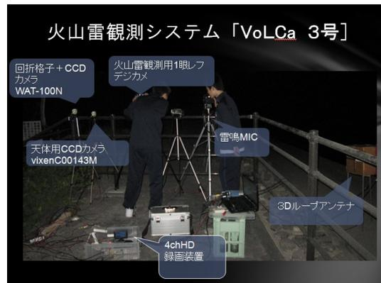
図. 完成した火山雷観測システム
